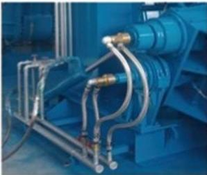
nuevo diseño del sistema hidráulico de descarga
