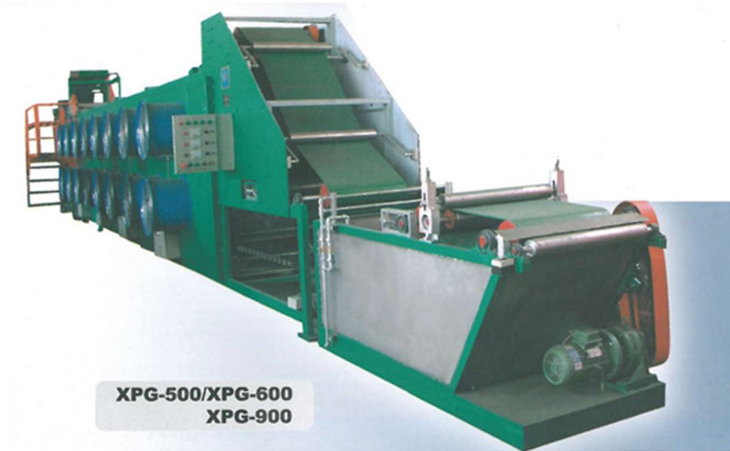
Este es el auxiliar rio abajo del mezclador interno. También puede trabajar con una extrusora mezcladora. Está diseñado para enfriar la manta de caucho en modo de operación en continuo.
