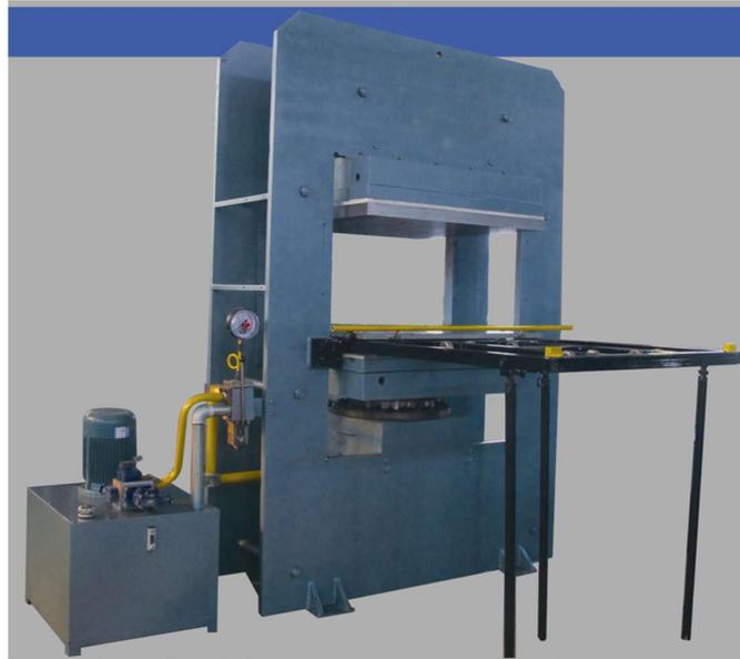
Esta prensa de marco, para vulcanización de artefactos de hule, tiene la capacidad de mover afuera el molde al termino del ciclo de vulcanización.
