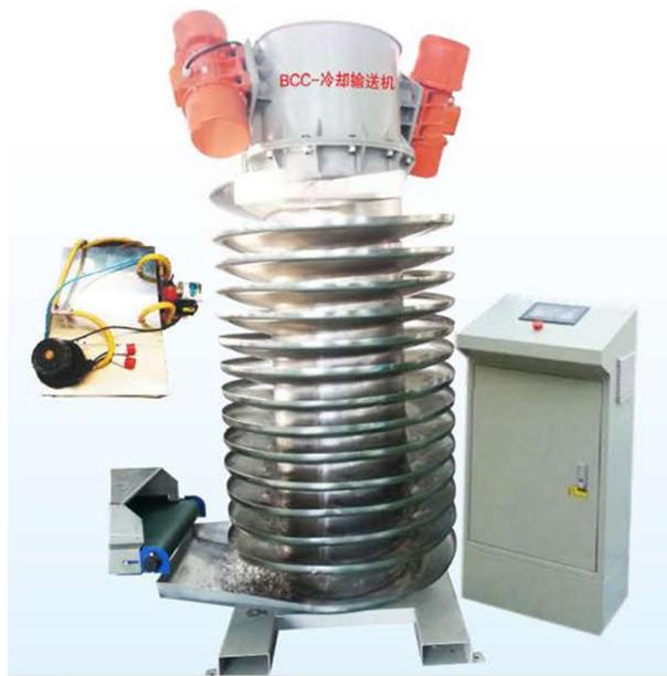
Este carrusel enfriador está especialmente diseñado para trabajar con las preformadoras. Sus principales funciones son enfriar, secar e mantener las preformas separadas mientras se enfrían, para evitar que se peguen entre ellas.
