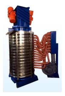
El enfriador **GCC** está diseñado para arreglar el problema de la adhesividad y deformación de las preformas. Es un equipo auxiliar de las preformadoras. Está fabricado em acero inoxidable SUS304. Esta máquina es cerrada por protección em policarbonato para evitar la contaminación de las preformas blancas o de colores claras, por los polvos. Esta protección también mejora la eficiencia del enfriamiento.
