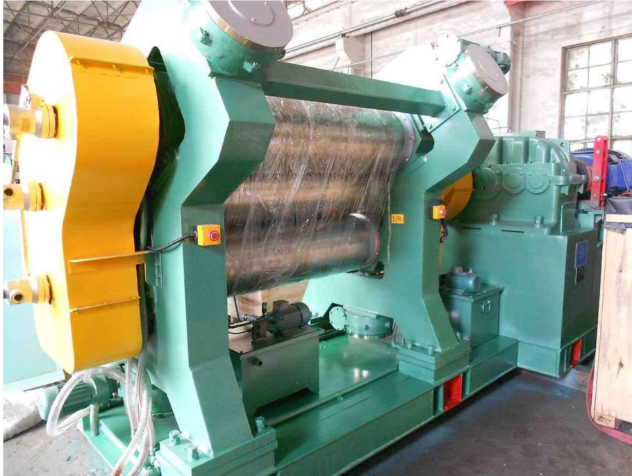
Ilustración 1 Calandria XY4F-450x1500, 4 rodillos en L invertido
